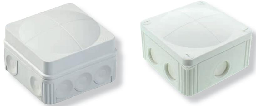
Die RED Kabelabzweigkästen aus 2-Komponenten-Kunststoff sind durch ihre Schlagfestigkeit und Bruchsicherheit für die Installation im Außenbereich bestens geeignet. Sie sind aus witterungs- und UV-beständigem Kunststoff und unabhängig vom RAL-Farbtönen. Zudem besitzen sie eine hohe Beständigkeit gegenüber pflanzlichen und tierischen Fetten, Mineralöl, Diesel, schwachen Säuren, Lauge sowie Alkohol.
