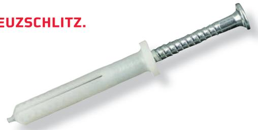
Der verzinkte Nagel sichert eine hohe Korrosionsbeständigkeit. Der Schlag-/Nageldübel besitzt einen schlaggeschützten Kreuzschlitz und schützt somit vor einer Beschädigung des Antriebs. Die Einschlagsicherung verhindert ein vorzeitiges Spreizen.
